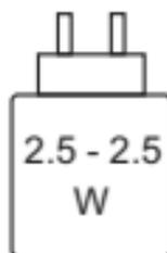
Die Leistung des Ladegeräts muss eine von der Funkanlage benötigte Mindestleistung von 2,5 Watt und eine zum Erreichen der maximalen Ladegeschwindigkeit benötigte Höchstleistung von 2,5 Watt betragen.
